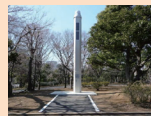
電子基準点 出典: 国土地理院ホームページ 隣接する国会前庭には、日本水準原点と電子基準点があるから見てね。
