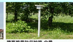
積算線量計収納箱 全景
