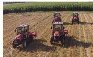
4台同時のロボットトラクター協調作業(世界初)
