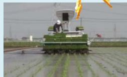
田植機やコンバインへの 高精度GPSの適用
