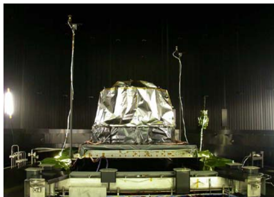
測位信号アンテナ エンジニアリングモデル熱平衡試験 (H19.2) 【文部科学省】
