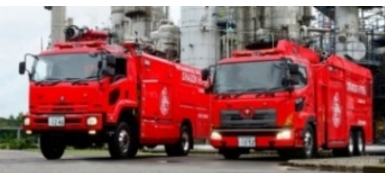
エネルギー・産業基盤災害対応 型消防水利システム
