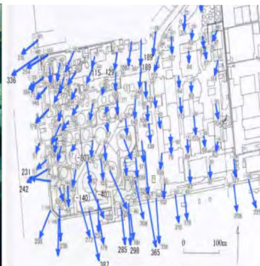
阪神大震災時の神戸港の液状化・護岸側方流動の教訓（護岸が沖合に流れ、神戸港の物流機能にダメージを与えた） 早稲田大学 濱田政則教授資料より
