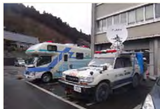
衛星通信車による通信回線の確保
