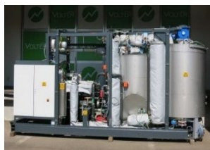
木質バイオマス利用熱電併給装置
