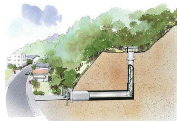
〔津波避難シェルター〕
