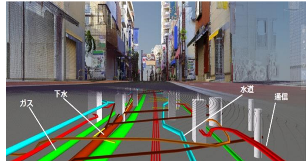
3Dマップはタブレット等の端末で工事中にも確認可能
