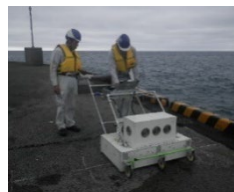
レーダー探査機による岸壁の空洞化調査
