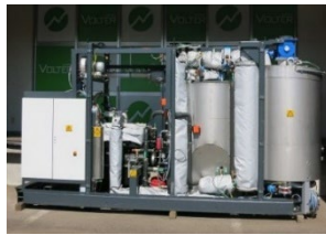
木質バイオマス利用熱電併給装置
