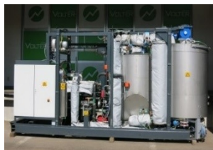
木質バイオマス利用熱電併給装置
