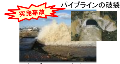
パイプラインの破裂による 用水供給機能の停止 開水路の補修
