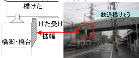
橋りょうの補強
