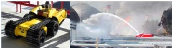
情報収集ロボット 放水ロボット(無人走行放水車)
