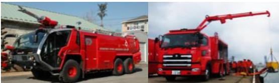
①エネルギー・産業基盤災害即応部隊(ドラゴンハイパー・コマンドユニット)を新設し、大容量放水等を可能とする消防水利システム(大型放水砲搭載ホース延長車、大容量送水ポンプ車)の配備
