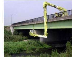
橋梁点検車を使った橋梁点検
