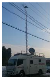
【移動基地局の設置】
