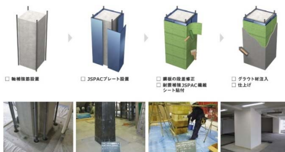
【耐震構造の比較と JSPAC 耐震工法の施工の様子】
