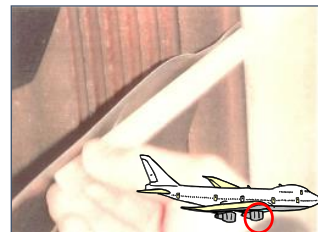
・コンクリート片を吸い込み ・エンジブレード破損
