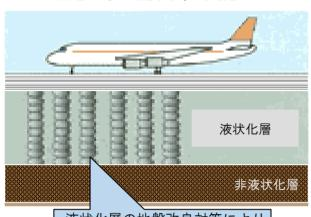
液状化層の地盤改良対策により、 舗装の損壊を防止
