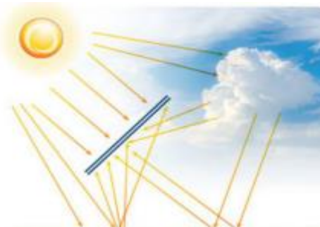
両面発電パネルの概要
