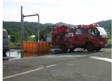
▲ 給水栓からの給水の様子
