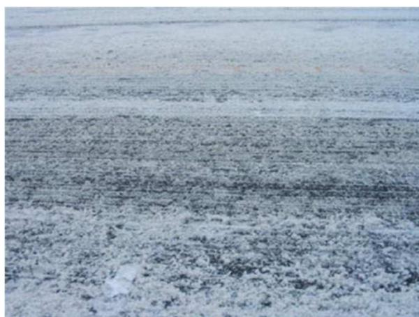
▲上が一般的な散布剤、下側が開発した製品
