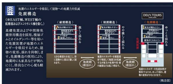
▲同マンションの免震構造について
