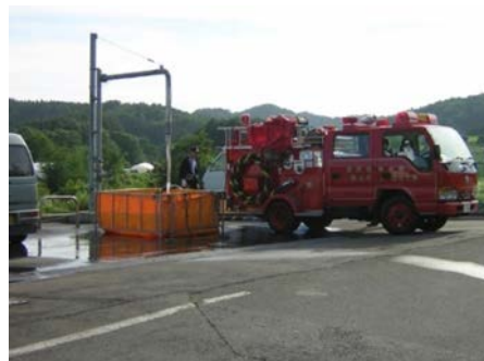
▲給水栓からの給水の様子
