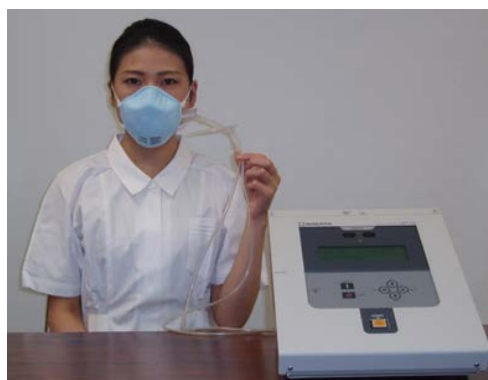
▲マスクの漏れ率を測定する様子
