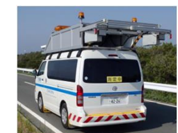
3次元レーザーセンサ を用いた舗装損傷検知
