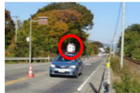
車載装置による路面性状測定
