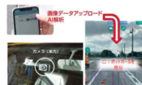
スマートフォンやドライブレコーダー による舗装損傷検知
