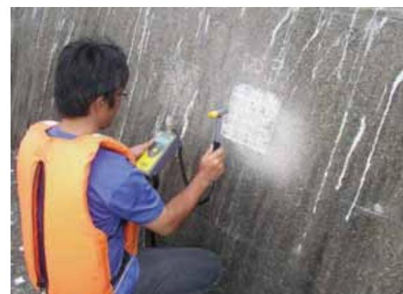
防波堤の上部工などの無筋コンクリート構造物に対する衝撃弾性波法（機械インピーダンス法）による圧縮強度の推定の様子
