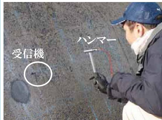
防波堤の上部工などの無筋コンクリート構造物に対する衝撃弾性波法（表面P波法）によるひび割れ等の変状把握の様子
