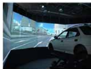
研究用ドライビングシミュレーター (国総研・慶應義塾大学共同開発)
