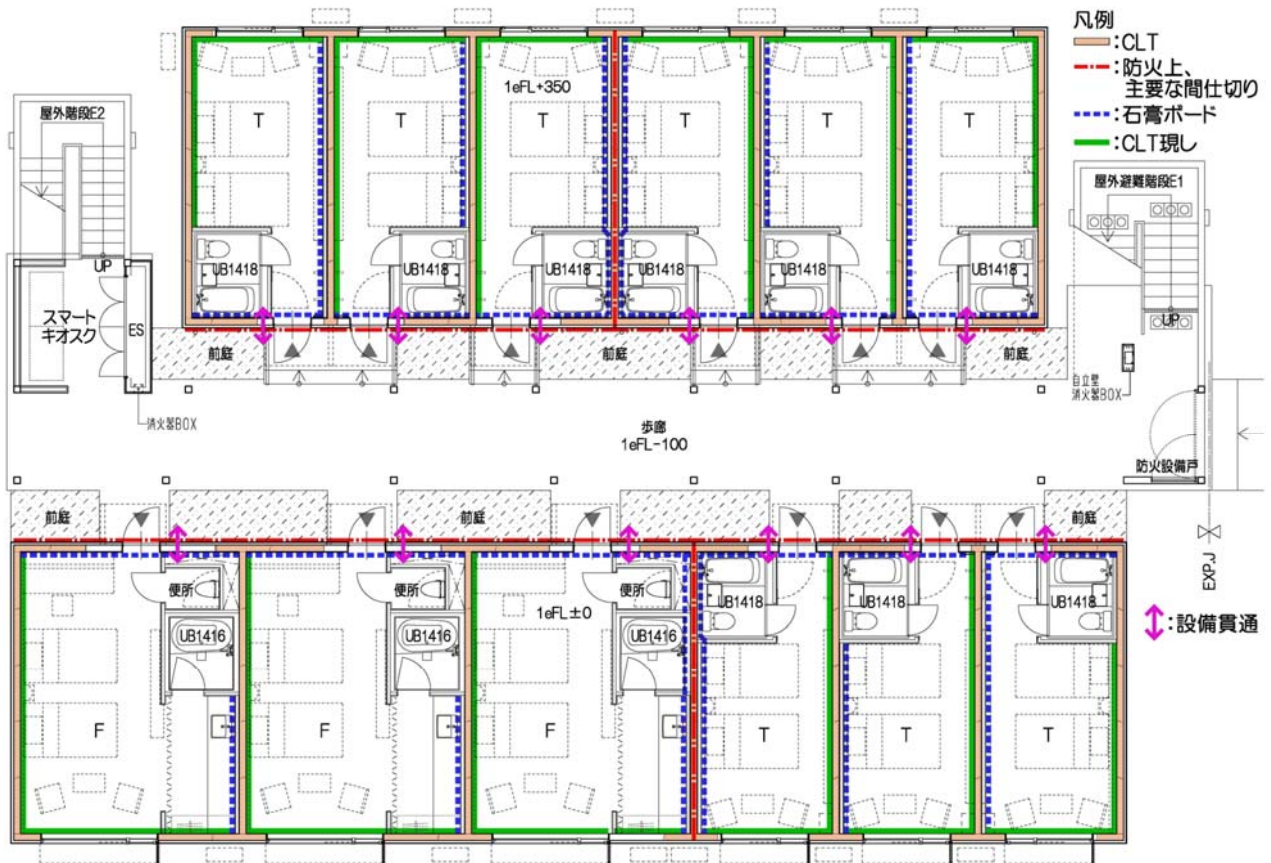
壁面2面にCLT現し実現のための工夫
