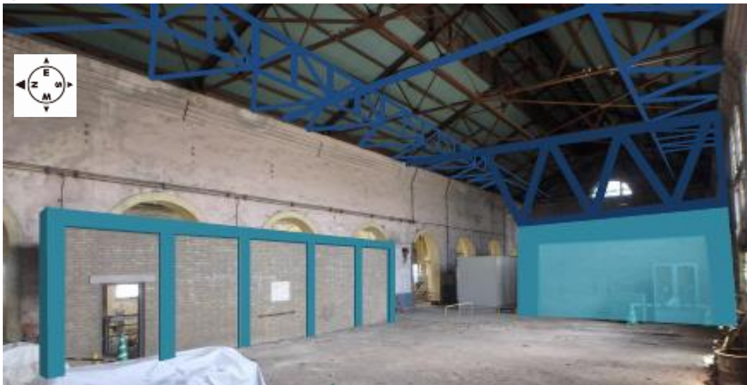
⑦補強概要図（電気室側パース図）
