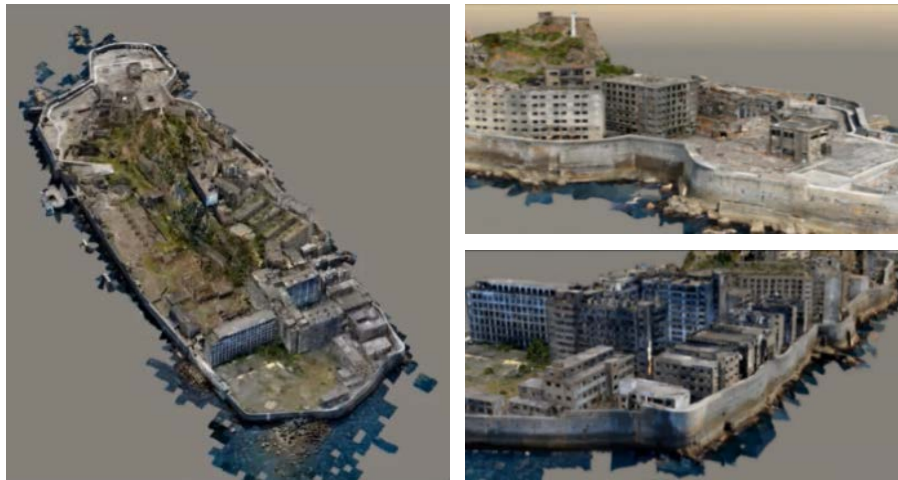
図 4 「3Dレーザー計測」で作成した端島炭坑3Dモデル
