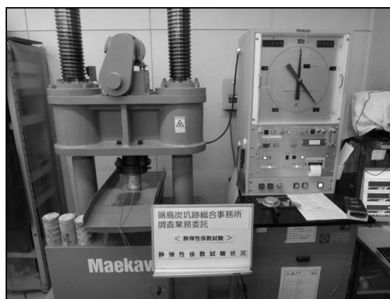
写真 2-4-70 圧縮強度・静弾性試験試験状況
