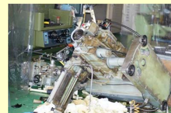
転倒、破損した研究設備 (東北大学)
